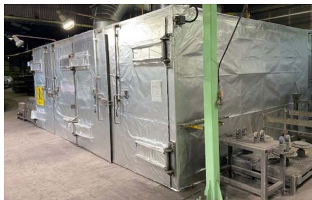
写真5-1 遮熱シートを施工した乾燥炉
