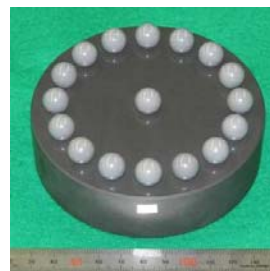
自動車用の歯車等のピッチを測定する基準器
