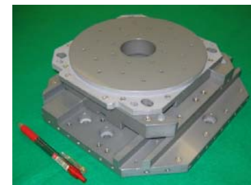
携帯電話のカメラ用非球面レンズの金型加工機向け部材
