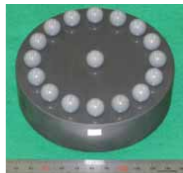
ギヤピッチマスター ("NEXCERA"®ゼロ膨張セラミックス製) 自動車用の歯車などのピッチを測定する 際の基準器
