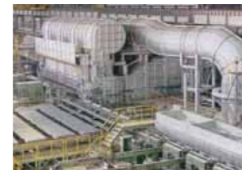
当社設計の工業炉 (プッシャー式ピレット連続式圧延加熱炉)
