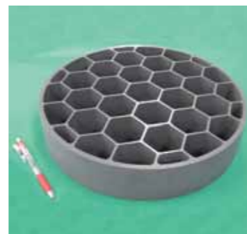
リブミラー(サイアロン製) 光学機器(レーザー測定器や天体望遠鏡 など)用の軽量反射ミラー(裏面)
