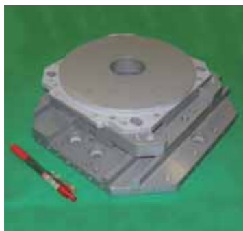
XYステージ(サイアロン製) 携帯電話のカメラ用非球面レンズの 金型加工機向け
