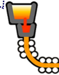
溶鋼鍋/連続铸造設備
