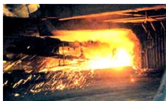
<マッド材> 高炉の出銑口を閉塞する 粘土状の耐火物
