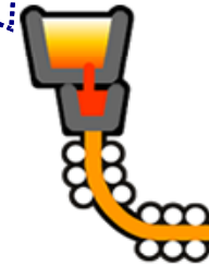
溶鋼鍋/連続製造設備
