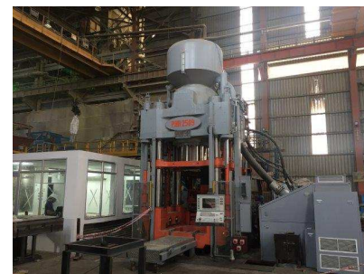
ドロマイト工場新成形機は稼動を開始。今年度中に新トンネルキルンが稼動開始予定。
