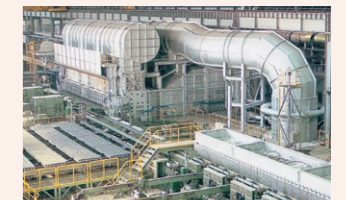
プッシュャー式ビレット連続加熱炉
