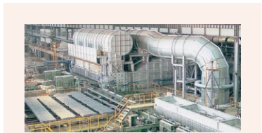
プッシャー式ピレット連続加熱炉
