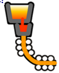
溶鋼鍋／連続鑄造設備
