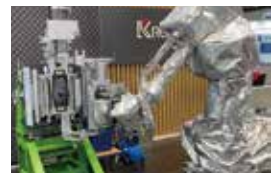
溶鋼流量制御用耐火物交換ロボット
