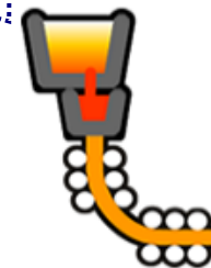
溶鋼鍋／連続鋳造設備
