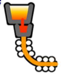
溶鋼鍋/連続铸造設備
