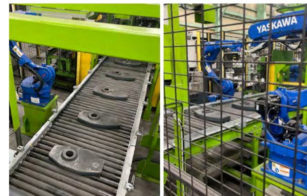
耐火物検査自動化ライン
