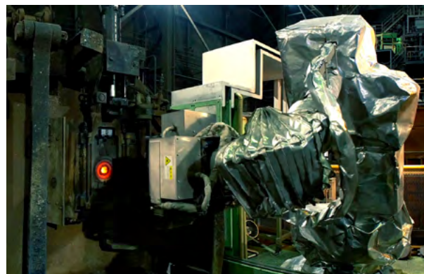
自社開発の耐火物交換ロボット (REX-ROBO® LSG)
